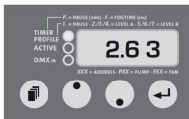
Abb. 20: Einstellen der Pumpen-Wertes
